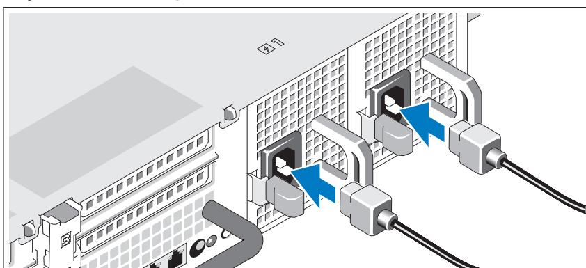
Sistemin güç kablolarının sisteme bağlantısını yapın ve bir monitör kullanılıyorsa, monitörün güç kablosunun monitöre bağlantısını gerçekleştirin.
