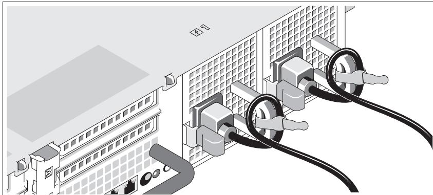
Faites une boucle avec le câble comme indiqué dans l'illustration, puis fixez-le au support à l'aide de la sangle fournie.
