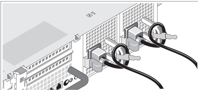
Zegnij kabel zasilania systemu w pętlę, jak przedstawiono na rysunku, i zamocuj kabel na wsporniku, używając załączonej opaski.
