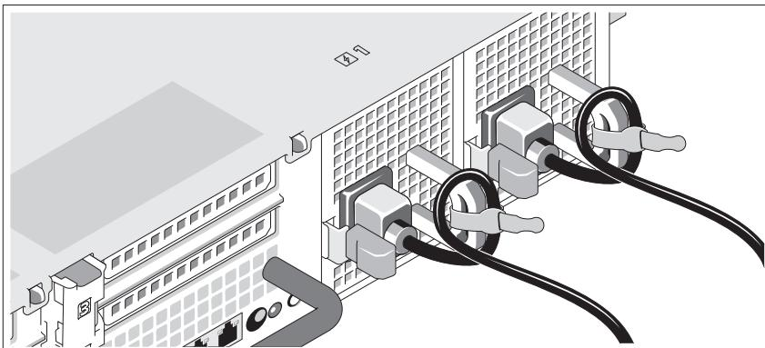
Изогните кабель питания системы в форме петли, как показано на рисунке, и прикрепите его шиной к прилагаемой скобе.
