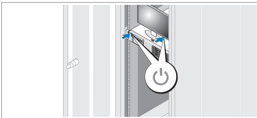
Sistem ve monitör üzerindeki güç düğmesine basın. Güç göstergeleri yanmalıdır.
