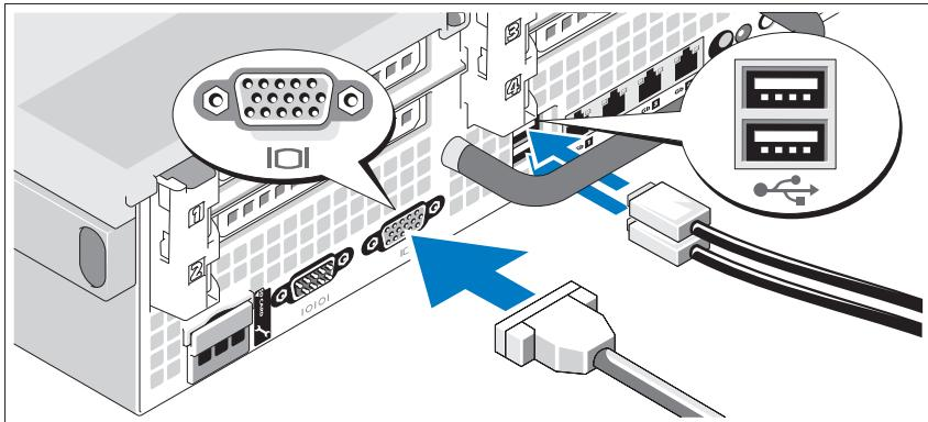
Подключите клавиатуру, мышь и монитор (дополнительно).
