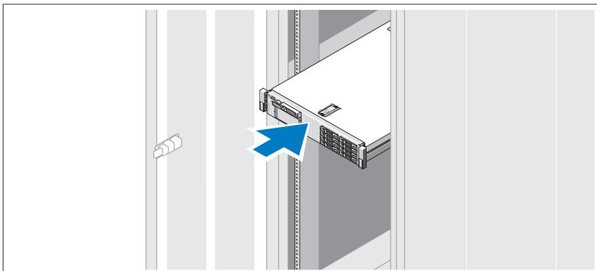
Смонтируйте направляющие кронштейны и установите систему в стойку согласно инструкциям по технике безопасности и инструкциям по установке стойки. Эти инструкции прилагаются к системе.
