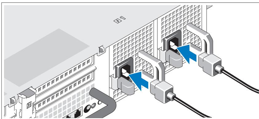
Schließen Sie das/die Netzkabel des Systems an das System an, und schließen Sie anschließend auch das Bildschirmstromkabel an den Bildschirm (falls verwendet) an.
