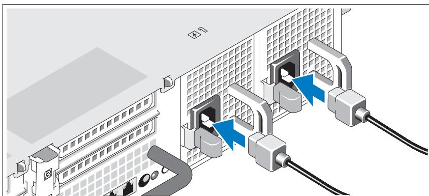
Подключите электрический кабель (кабели) к системе. Если используется монитор, также подключите к нему электрический кабель монитора.
