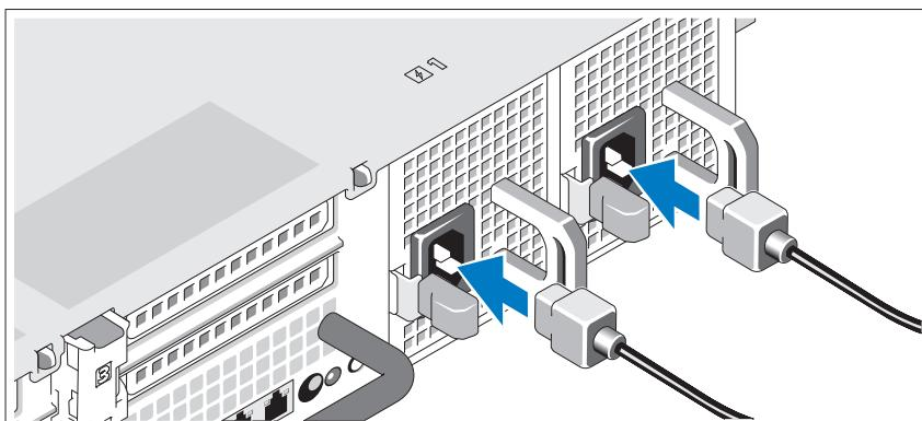
Podłącz odpowiedni kabel (lub kable) zasilania do systemu oraz do monitora, o ile używasz monitora.
