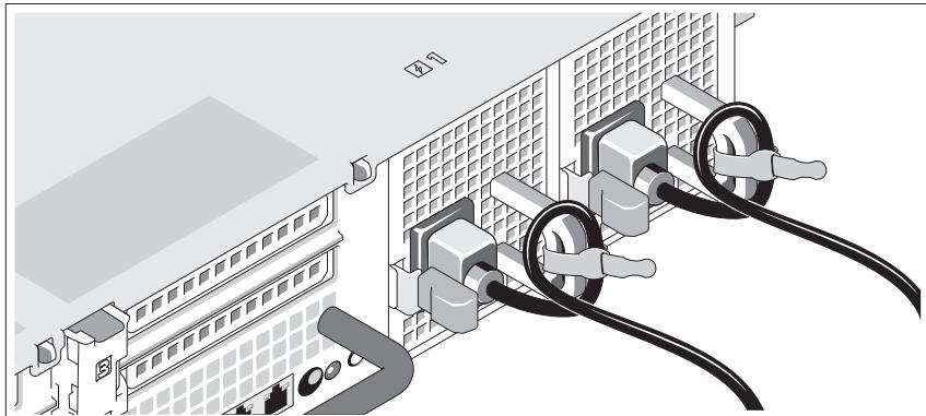
Bilden Sie mit dem Systemnetzstromkabel wie abgebildet eine Schlaufe, und sichern Sie das Kabel mit dem beigefügten Band an der Klammer.
