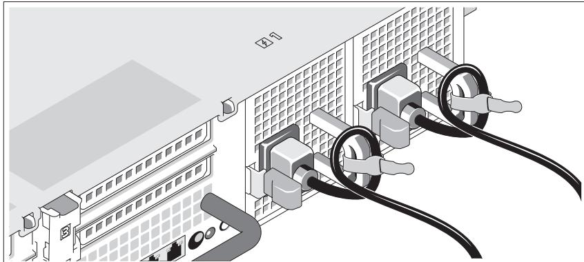
Ohněte napájecí kabel systému do smyčky, jak je znázorněno na obrázku, a připevněte jej dodanou páskou k držáku.
