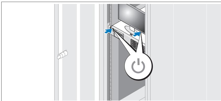
Pulse el botón de encendido del sistema y del monitor. Los indicadores de alimentación deberían iluminarse.
