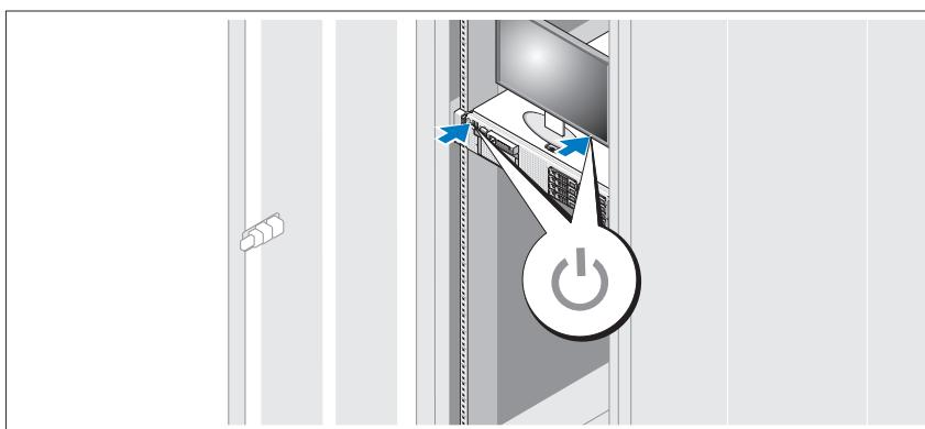
Нажмите кнопки питания на системном блоке и мониторе. Должны загореться индикаторы включения.
